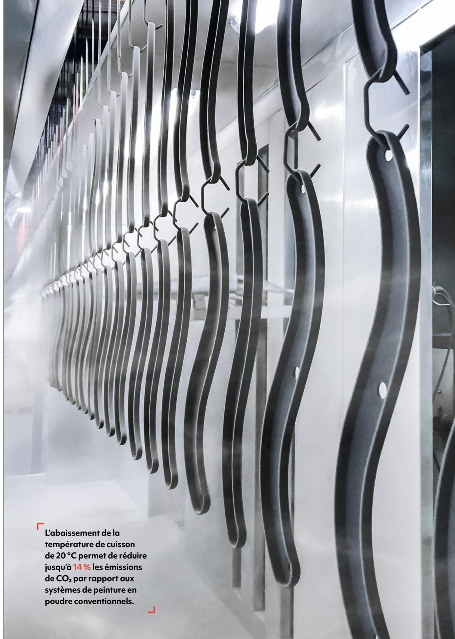
L'abaissement de la température de cuisson de 20 °C permet de réduire jusqu'à 14 % les émissions de CO<sub>2</sub> par rapport aux systèmes de peinture en poudre conventionnels.
