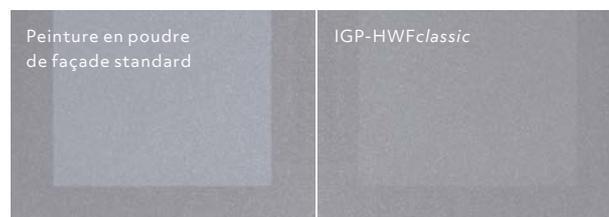
Test de résistance aux rayures avec l'appareil de test Martindale. Traces d'entailles plus faibles, mesurables et visibles après rayage.
